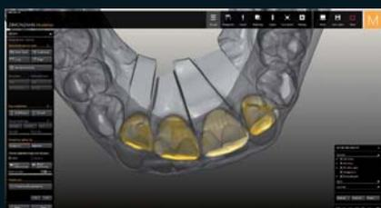
*Con l'integrazione della funzione "Adatta all'antagonista" nello "Strumento di modellazione libera", la modellazione è stata estremamente semplificata, specialmente nella lavorazione di strutture complesse.*
