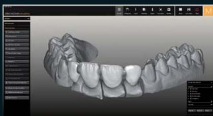
*Il "Master Menu" di "Zirkonzahn.Software" mette a disposizione del tecnico esperto centinaia di parametri configurabili individualmente per una maggiore personalizzazione e con la massima precisione dei dettagli.*
