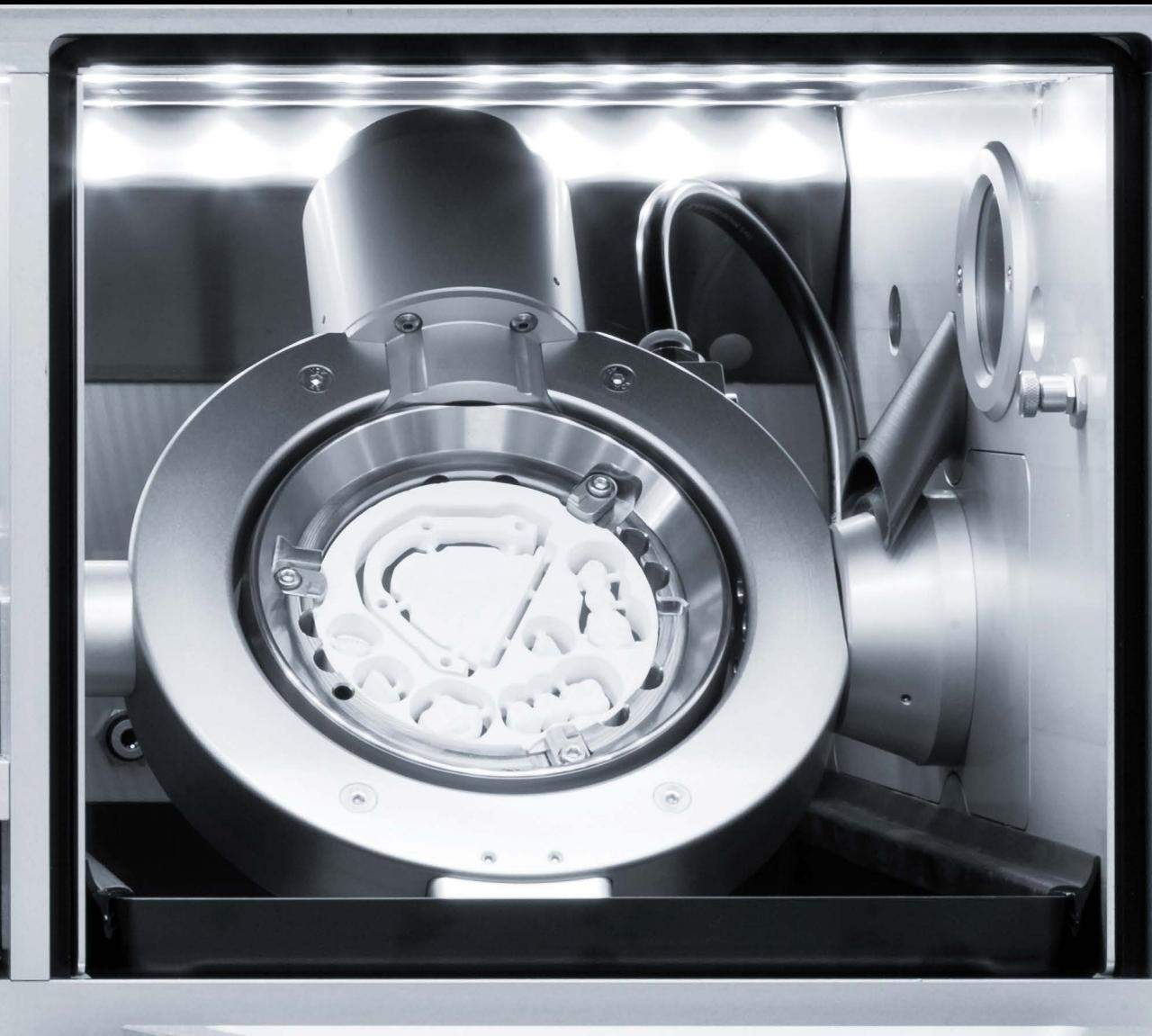
*Le camere di fresatura sono entrambe dotate di una funzionalità di cambio automatico delle frese. La camera porta-utensili, protetta dalle polveri, è particolarmente spaziosa e permette di disporre in modo ordinato gli utensili nuovi e usati.*
