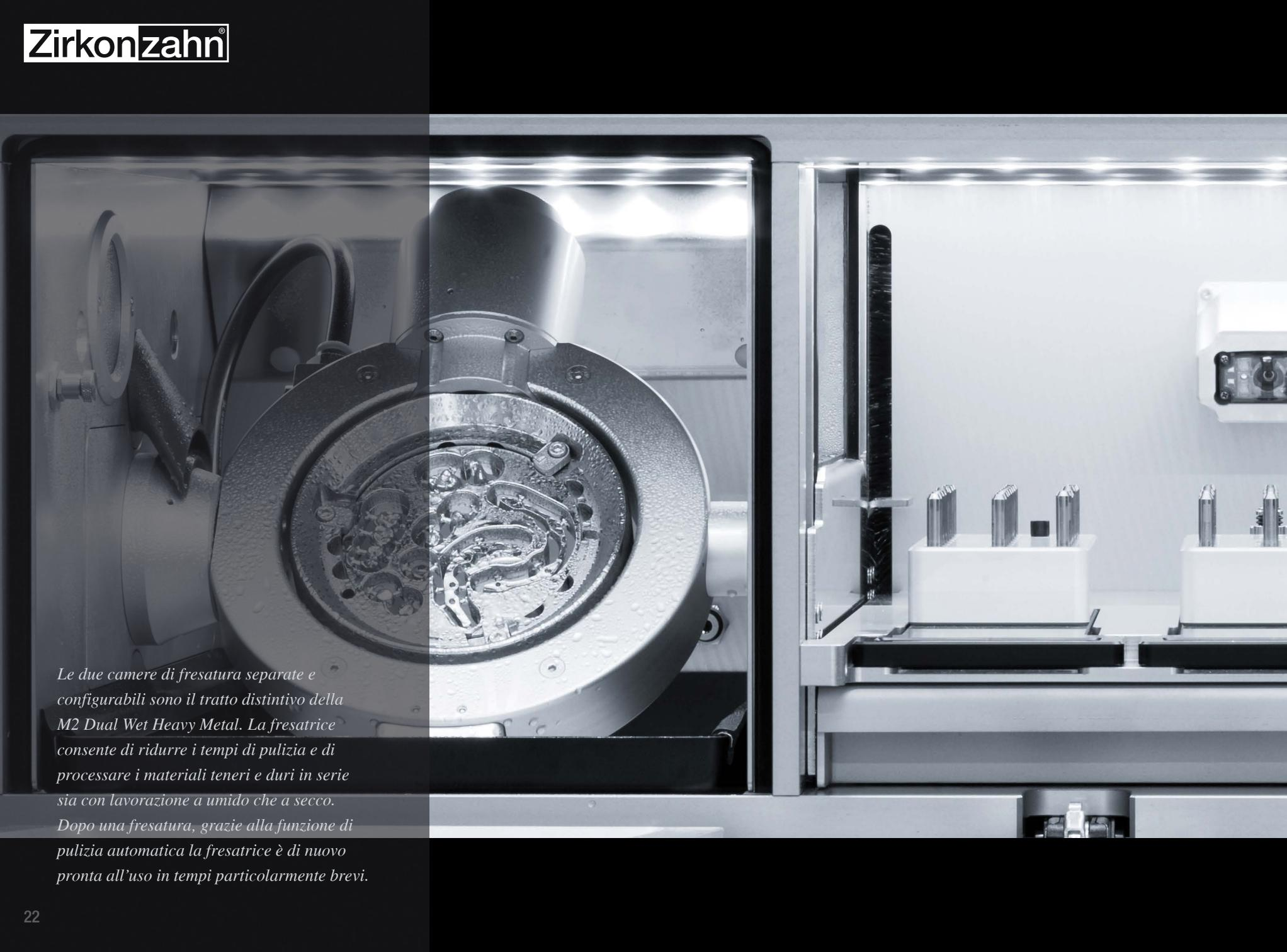
*Le due camere di fresatura separate e configurabili sono il tratto distintivo della M2 Dual Wet Heavy Metal. La fresatrice consente di ridurre i tempi di pulizia e di processare i materiali teneri e duri in serie sia con lavorazione a umido che a secco. Dopo una fresatura, grazie alla funzione di pulizia automatica la fresatrice è di nuovo pronta all'uso in tempi particolarmente brevi.*
