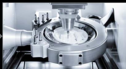
*Fresatura ad alta precisione del restauro finale in zirconia nella fresatrice Zirkonzahn. Colorazione (a seconda del materiale) e sinterizzazione della struttura fresata.*
