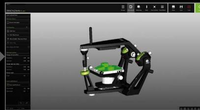
*Riproduzione fisica dell'articolazione digitale tramite la fresatura di una dima di posizionamento dal blocco JawPositioner; controllo nell'articolatore fisico PSI.*
