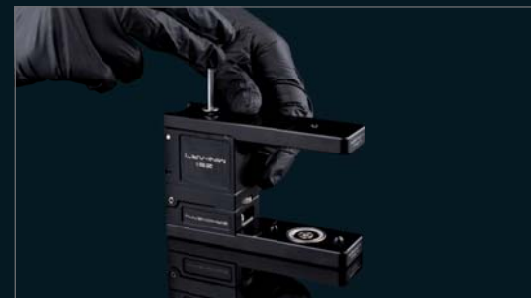
2. Avvitare il distanziatore magnetico Lower Jaw Low nella parte inferiore del Mini-Arti ZSI
