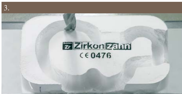
Fresare senza eccessiva pressione
