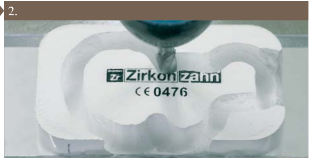
Fresare il bordo esterno con il fresatore 4L
