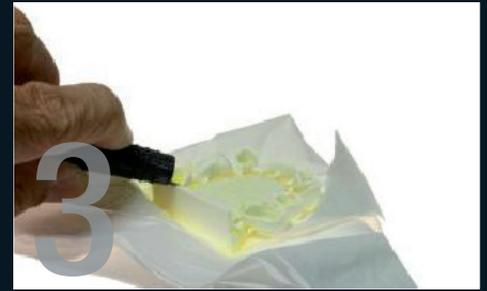
Überschüssige Farbe mittels Druckluft, über geeignetem Zellstoff, entfernen.
