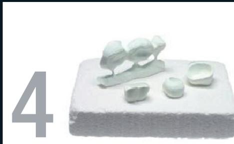
Auf Brenngutträger unter der Trockenlampe Zirkonlampe 250 trocknen; Durchführung unter Absaughaube oder im Freien wird empfohlen.
