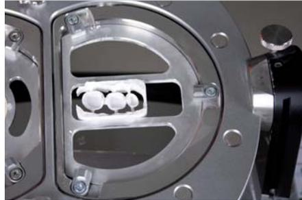
Nach dem Fräsen die Brücke innerhalb der Klebepunkte heraustrennen;
