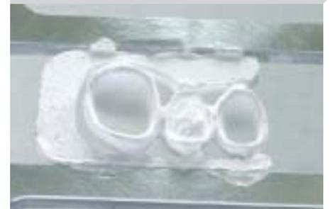
Fertig ausgefräste Arbeit - bereit zum Heraus-schneiden
