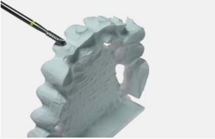
Nur dünnes, feinzahniges Schleifwerkzeug verwenden
