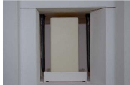
Brenngutträger mit Objekten und Haube mittig im Ofen positionieren
