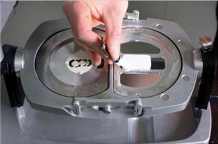
Zirkonblock mit Attak Flex Gel fixieren und mit dem Accelerator Spray härten
