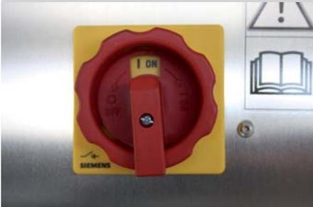
Ofen mit Hauptschalter einschalten: Schalterposition ON
