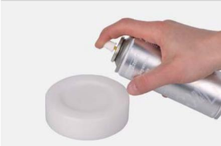
Oberfläche des Frameformers mit Frame Separating Spray einsprühen
