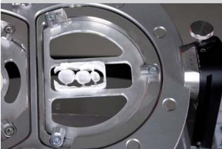
Brücke innerhalb der Klebepunkte heraus-trennen, dabei einen Fuß für den Sintervorgang stehen lassen
