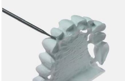
Maximale Drehzahl: 10.000 u/min; ansonsten können Sprünge entstehen
