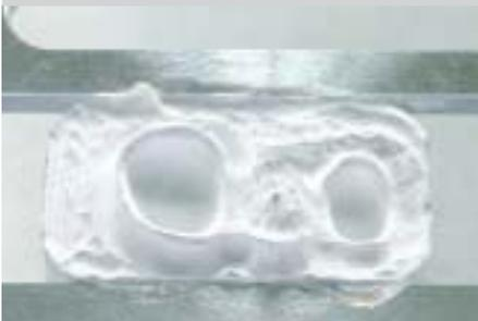
Mit 2L Fräser die Form genauer ausfräsen
