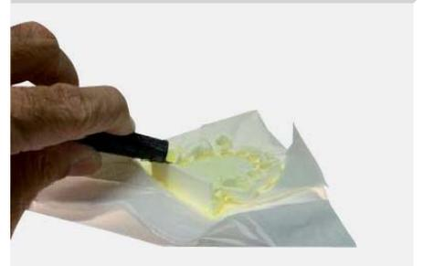
Getauchtes Gerüst im Taschentuch mit Druckluft abblasen
