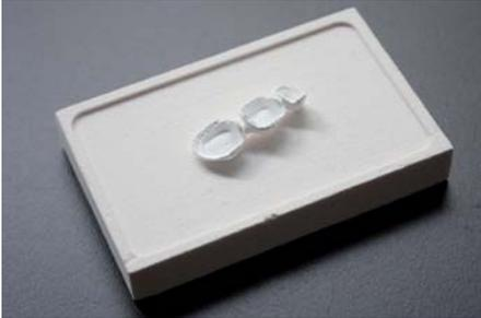
Objekte mit der Okklusionsfläche auf Brenngutträger legen und großspannige Brücken aufgestellt sintern
