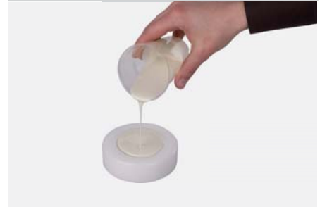
Pour mix into template mould
