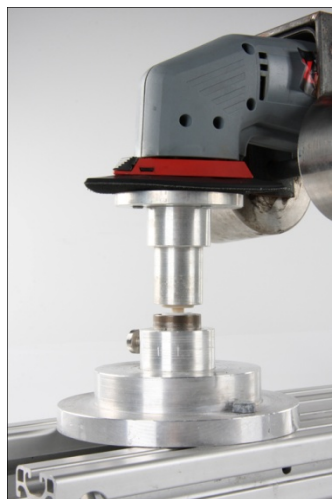
Figura 5 vista del contacto entre el indentador y la muestra.
