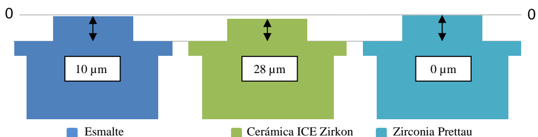
Figura 6, vista esquemática de la abrasión en el indentador de acuerdo a cada muestra.
