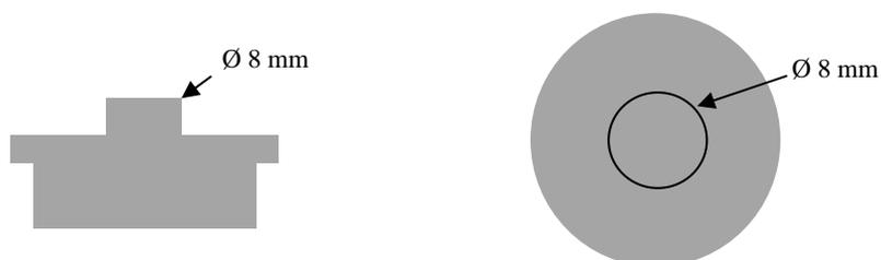
**Fig. 4** Schémas représentant le corps frottant (résine PMMA).
