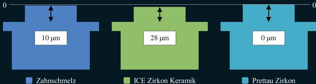
*Schematische Darstellung der Abnutzungseffekte durch die verschiedenen Probestücke bei 3.024 Millionen Kontaktzyklen am Reibkörper*
