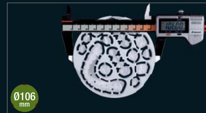
Ø106 mm 1 x arcada completa 2 x puentes de 4 unidades 11 x coronas individuales
