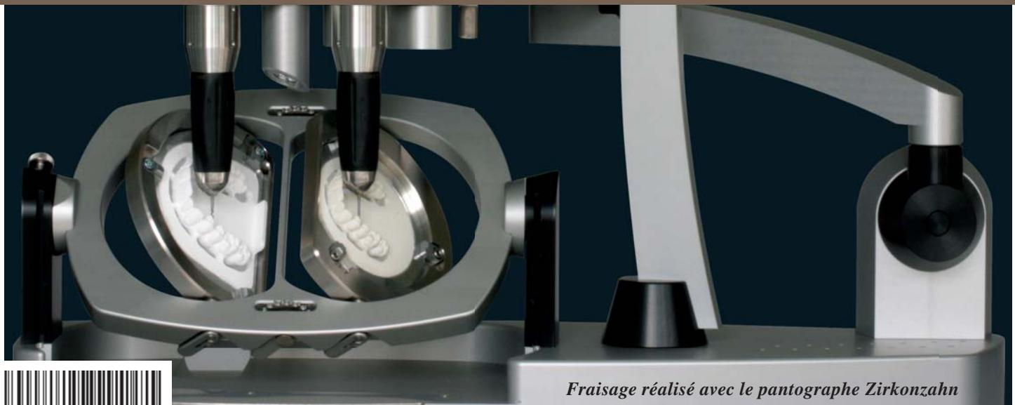
*Fraisage réalisé avec le pantographe Zirkonzahn*
