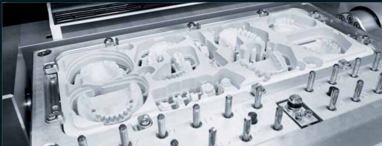
*En utilisant le bloc extra-large Model Blank M4, il est possible de fraisage jusqu'à 20 arcades complètes dans un seul processus de fraisage.*
