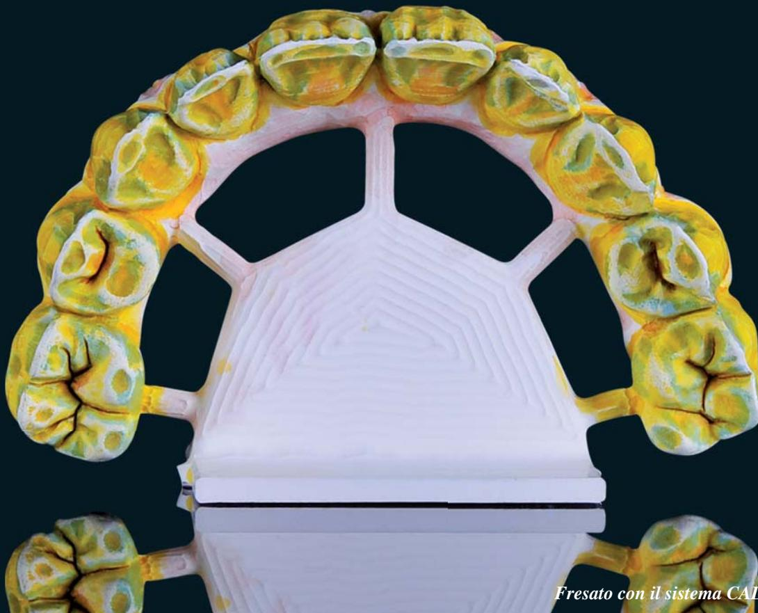
*Fresato con il sistema CAD/CAM 5-TEC*
