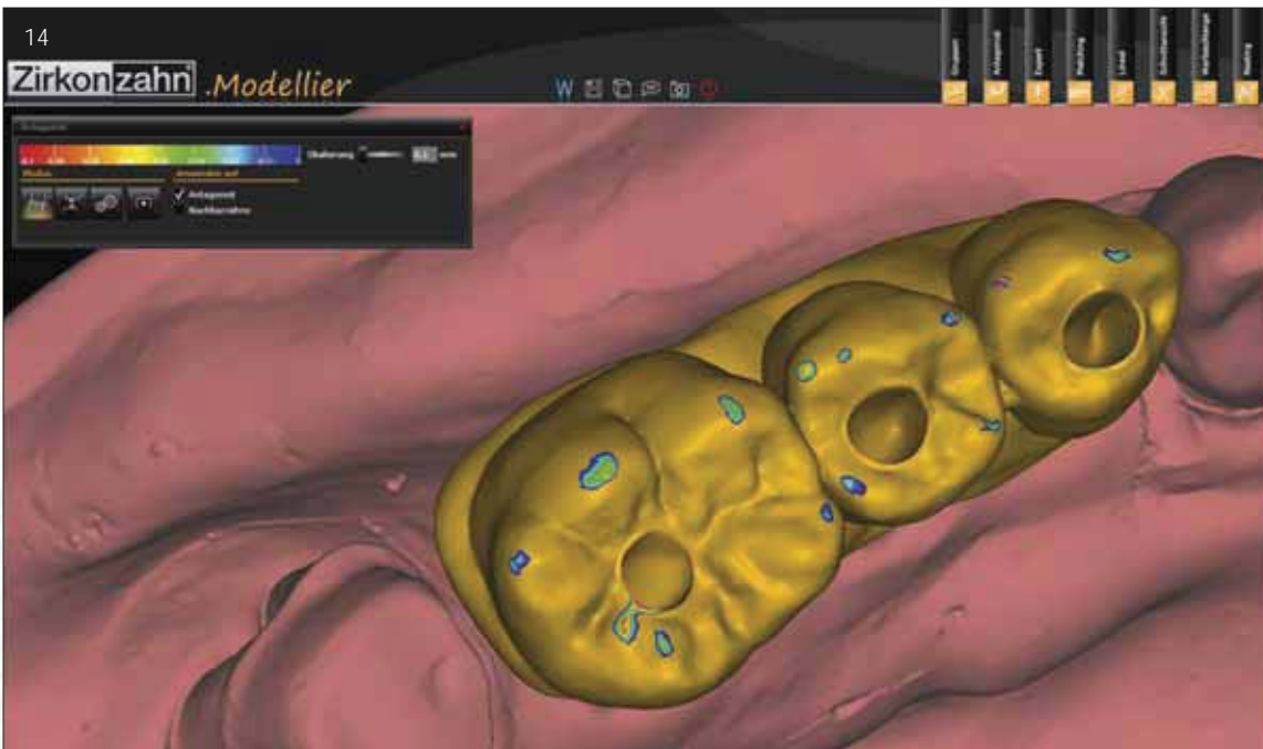
Abb. 14 Mithilfe des Software-Moduls „Virtueller Artikulator“ können die Kiefergelenkbewegungen in der Modellier-Software simuliert und dadurch Störkontakte und deren Intensität sichtbar gemacht und entfernt werden
