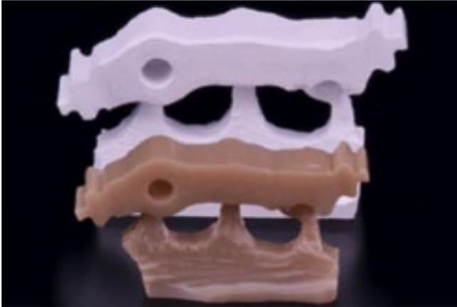
Abb. 13 Zirkonasteg im Rohzustand vor (oben) und nach (unten) Sinterung – Darstellung des Grössenunterschieds basierend auf einer Sinterschrumpfung von 20%
