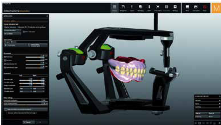
Abb. 3: Digitale, positionsechte Konstruktion einer Totalprothese in der Modellersoftware Zirkonzahn.Modellier im virtuellen Artikulator PS1. OK- und UK-Totalprothesen sind unter Berücksichtigung des Antagonisten auch einzeln realisierbar.
