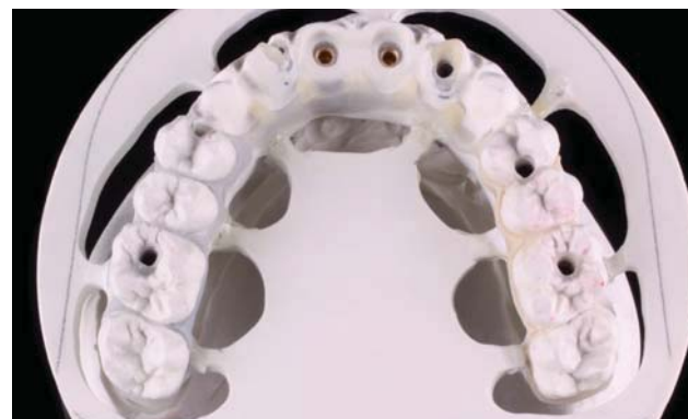
Abb. 5: Vor dem Fräsen wird die Konstruktion in eine passgenaue Frameplatte eingeklebt.
