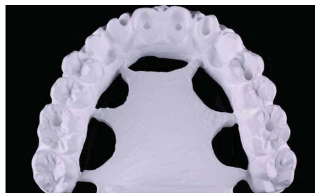
Abb. 7: Die identische Nachbildung in ungesintertem Zirkoniumdioxid.
