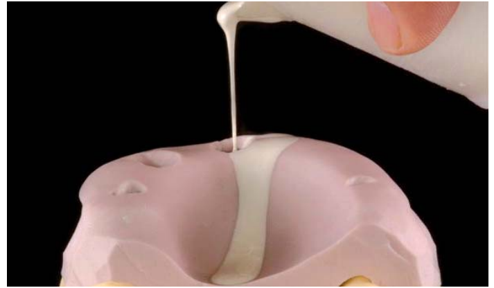
Foto 8: vaciado de FRAME sin contracción
