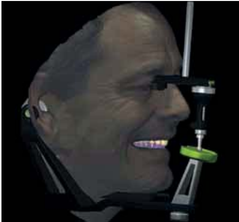
Fig. 16 Visualizzazione di un'immagine dello scanner facciale Face Hunter con i denti della libreria AIDA nell'articolatore virtuale PS1-3D nel software di modellazione Zirkonzahn.Modellier.
