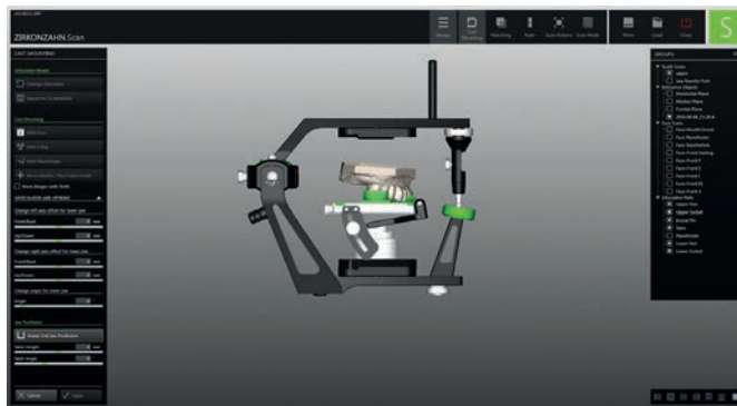
Fig. 10a, 10b og 10c – Den virtuelle artikulatoren og de fysiske artikulatorene med JawPositioner (Zirkonzahn)
